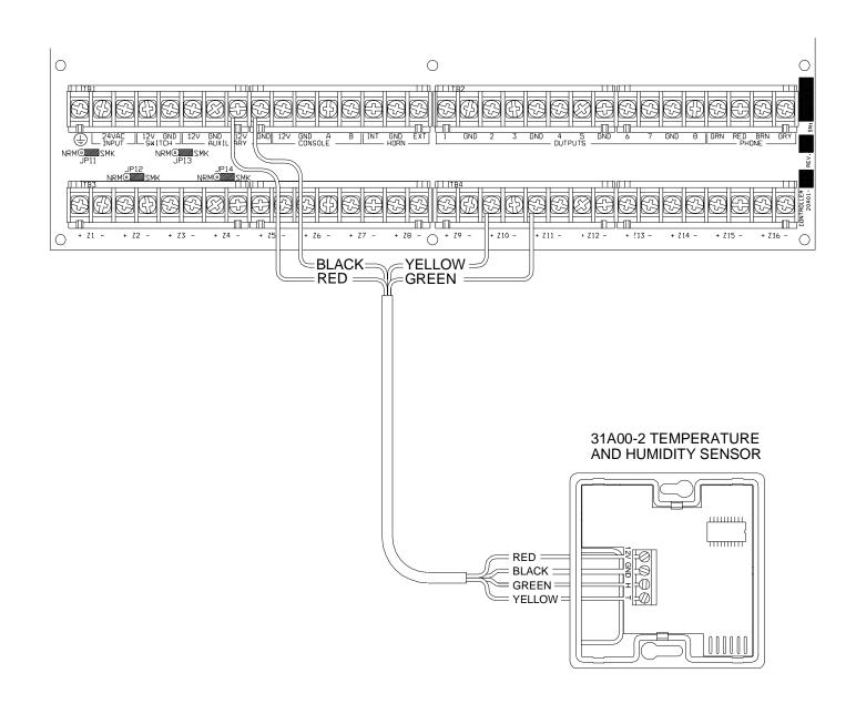
FIGURE 1 – MODEL 31A00-2 CONNECTIONS
